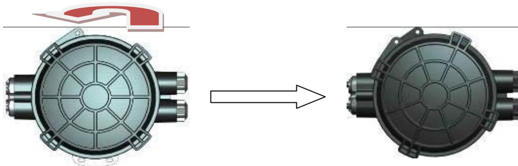
Retire los tornillos de la bandeja para sacarla, y retire los tapones de plástico de las entradas. Pase el cable ya pelado por el puerto doble.
