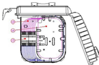
1. Cierre; 2.Bloqueo; 3 Cerradura;4 Junta placa 5.Plato Splitter; 6 Soporte Adaptador; 7.Adaptor; 8. Clip de Cierre; 9.Lid; 10.Base; 11 . Fijación Cable Alimentación; 12.Prensaestopa; 13. Gancho cierre. 14. Soporte para PLC; 15. Soporte fusiones; 16.Plato soporte fibra; 17.Soporte para Splitter; 18.Pig tail; 19.Aco- metida.
